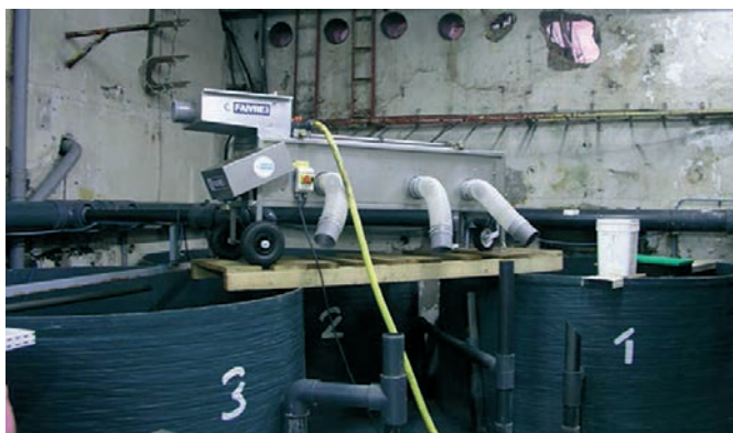
Obr. 4. Automatická třídička ryb využívaná v komerčních intenzivních chovech různých druhů ryb (foto T. Policar).
