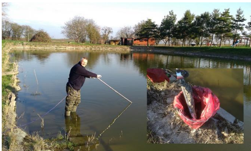
Obr. 3 Odběr vzorku z celé vrstvy sedimentu – rašelinová sonda
