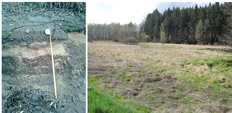
Obr 2 Meziroční nárůst sedimentu může činit až 35 cm - rybník Pod Struhařovem (vlevo), zhlaví rybníka Podlesník v Radňově zanesené sedimentem (vpravo)
