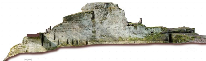
Obr. 10 Mlýnský rybník, ukázka pořízeného fotoplánu, pohled od východu, hlavní výpust ve skalní průrvě, zpracoval Ing. P. Hlavenka – Ing. J. Vidman 2015.
