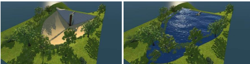
Obr. 9 Vizualizace- pohled na vypuštěnou nádrž (vlevo) a na nádrž při průchodu povodně (vpravo)
