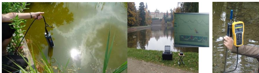
Obr. 5 Měření sondou YSI, batymetrie Podzámeckého rybníka a průtoků na přítocích (říjen 2016). Foto E. Maršálková
