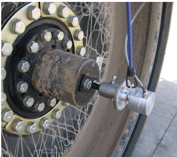
Obr. 7 – Inkrementální optický snímač otáček kola LARM
