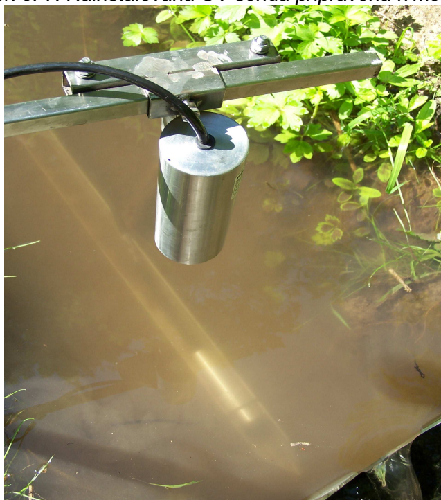
Obr. č. 7: Nainstalovaná UV sonda připravená k měření
