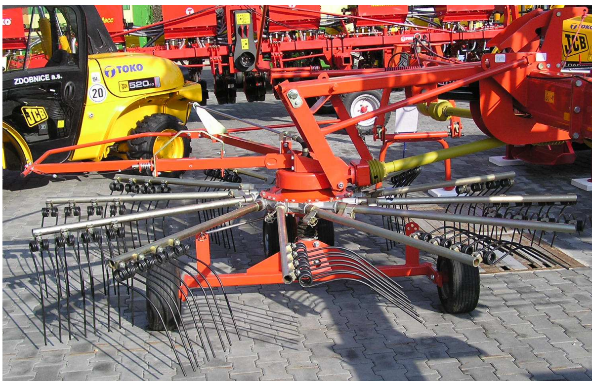
Obr. 2 Detail shrnovacího rotoru
