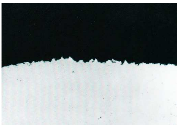
Obr. 1 Povrch navařeného vzorku (100 x Zvětšeno)
